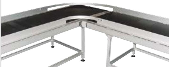
Estructura de soporte con perfil **item** 80x40 integrada en el transportador.
