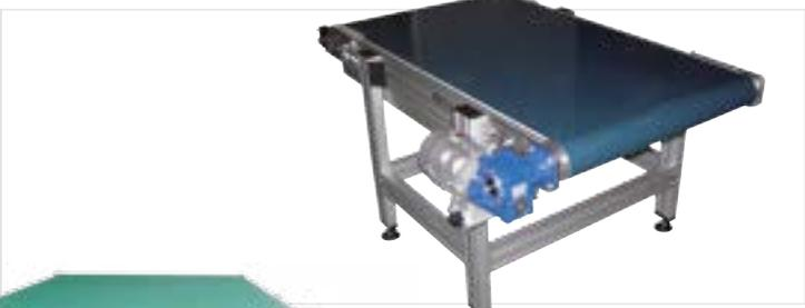
Transportador con banda de PU. A=1.600 mm.
