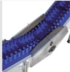
Bastidor de aluminio anodizado Sinerges serie 8/6/5.
