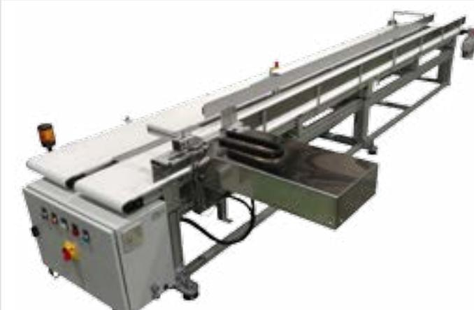
Estructura regulable en altura por columnas hidráulicas.
