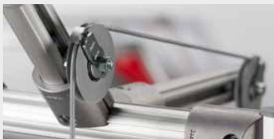
A menudo es necesario redireccionar los cables para crear estructuras compactas y eficientes. La polea de cable D42/D6-12 proporciona una guía sencilla y segura para los cables. Esta polea de alta calidad con rodamientos de bolas puede atornillarse directamente al perfil con o sin casquillos espaciadores. La placa de anclaje incluida en el suministro evita que el cable se salga de la polea.
