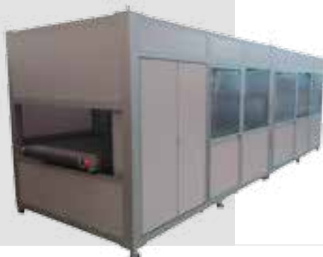
Transportadores integrados en cabina de inspección XMS item.
