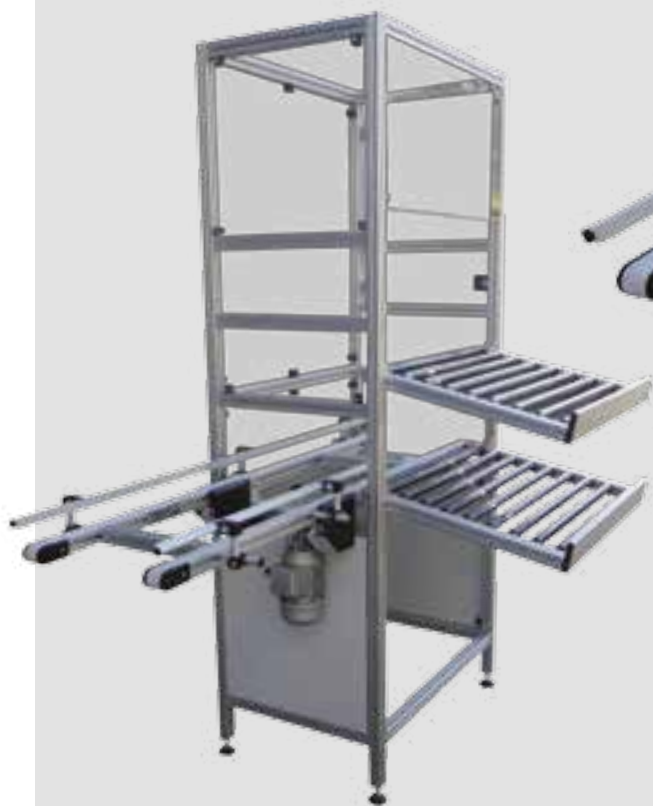
Transporte de tapones de plástico con protección para sala limpia.
