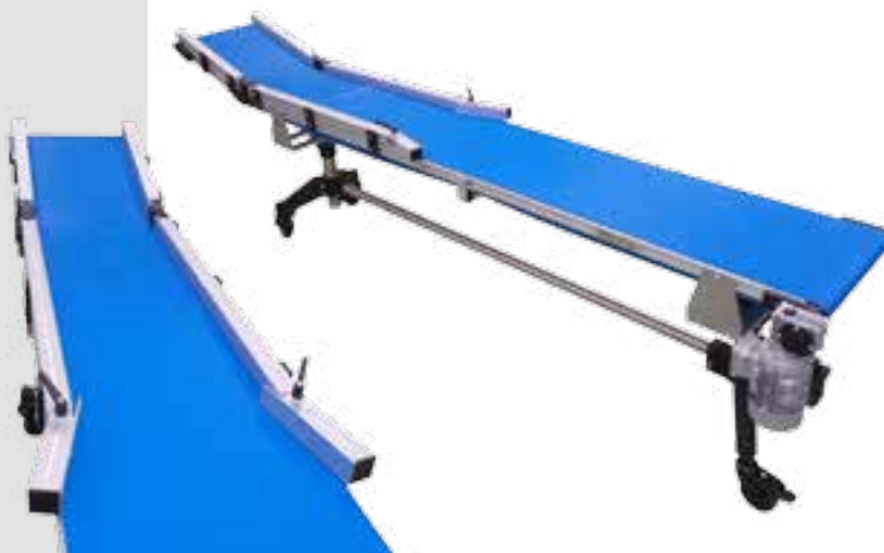
Transportador articulat amb banda PU alimentària antibacteriana.
