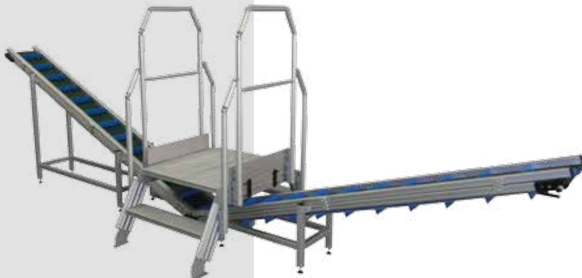
Transportador articulat per pas inferior amb plataforma TPS .
