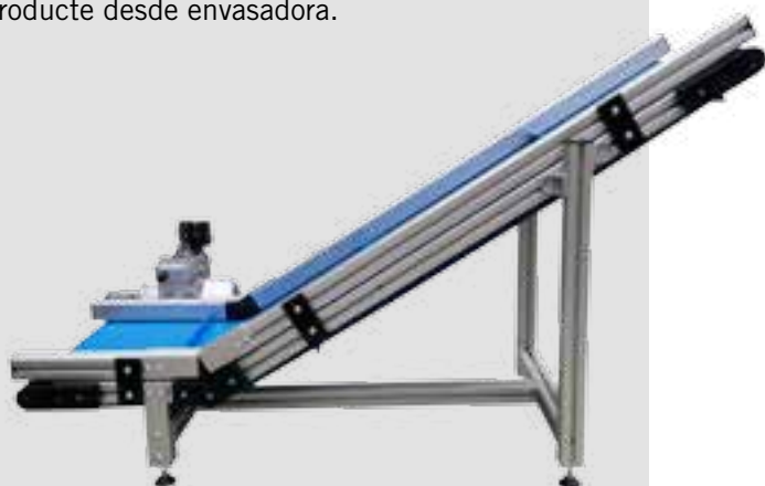
Transportador elevació de producte desde envasadora.
