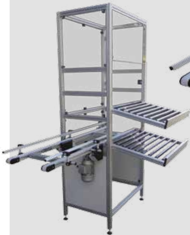
Transport de taps de plàstic amb protecció per sala neta.
