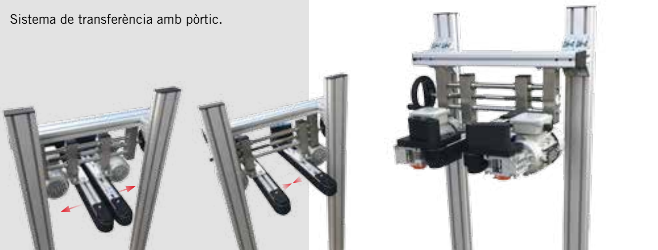
Transferència lateral amb STT100E - corretja dentada AT10 amb recobriment d'escuma.
